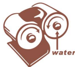
滾筒混鍊重新架橋
